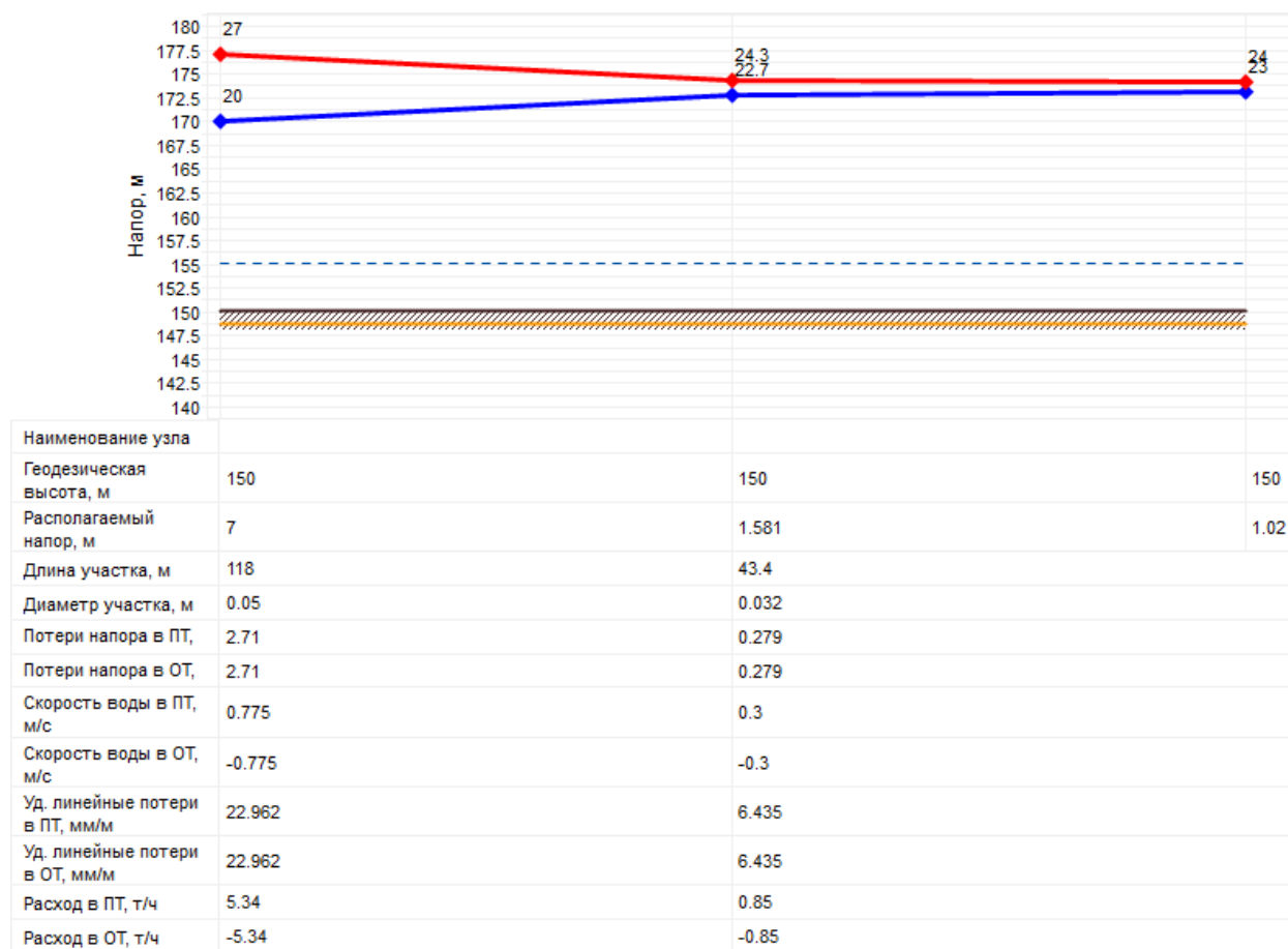
Рисунок 2.6 – Пьезометрический график тепловой сети котельной с. Копыловка
